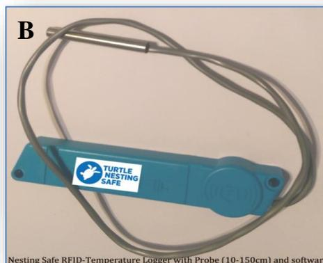
**Figura 13.** Nesting Safe RFID nido etiquetas (A), y temperatura registradores de datos (B)
